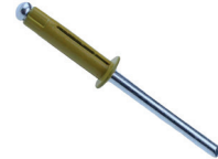
Kentekenplaatnagel triform geel alu/alu 4,8x20,5 (3,0-9,0)
