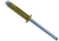
Kentekenplaatnagel triform geel alu/alu 4,8x24,5 (5,0-12,0)
