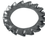
Tandveerring DIN6798A electrolitisch verzinkt M12
